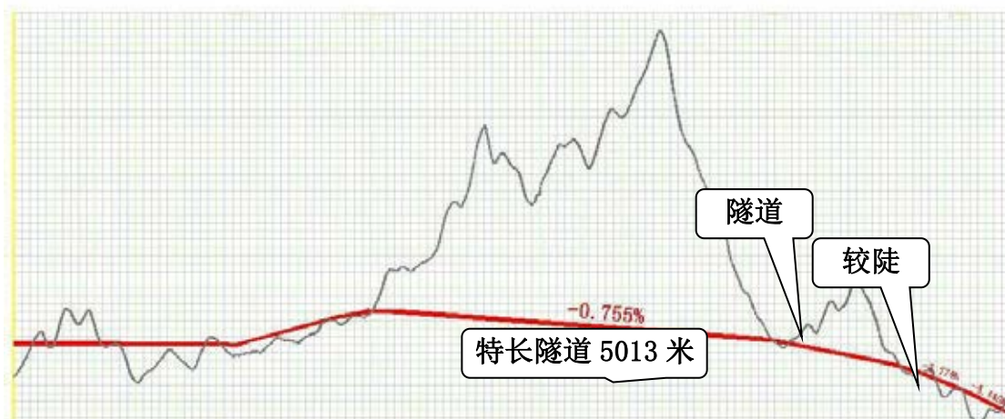
图 2.2-6 F 线纵断面图
